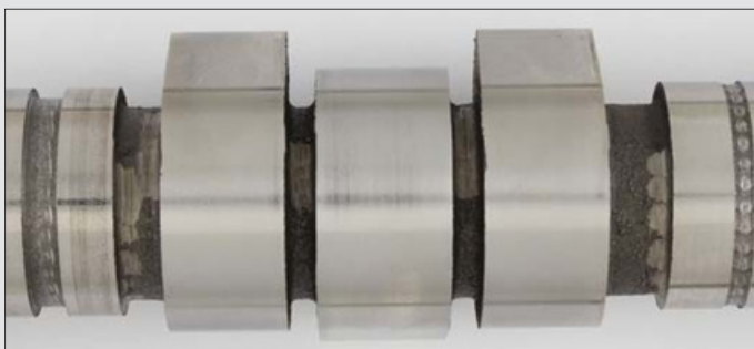
หลังจากผ่านการทดสอบอย่างเข้มงวดโดยหน่วยงานอิสระภายนอก ลูกเบี้ยวแทบจะไม่แสดงร่องรอยการสึกหรอเลย
