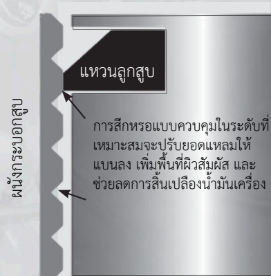
ภาพที่ 2 : กระบอกสูบหลังผ่านการรันอิน
